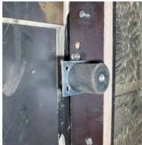
Skotterne er blevet monteret på gummiklodser. (Foto: Karsten Korsgaard)
