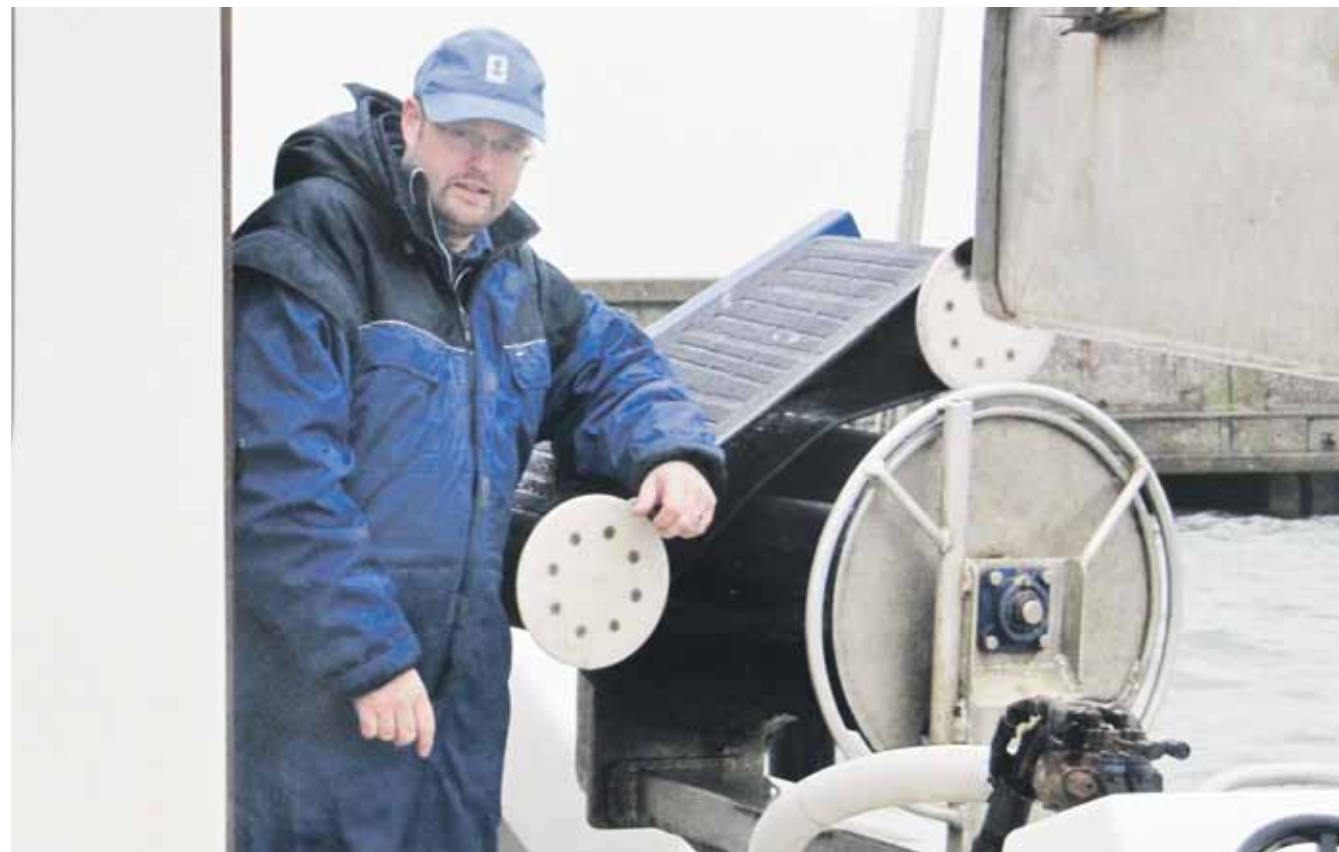
Bo Kjeldgaard har netop hentet de sidste ruser hjem for i år, men han glæder sig over den kombinerede garn- og rusehaler, der har fjernet noget af det tunge arbejde ved hummerfiskeriet. Foto: Lone Hansen
