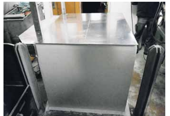
Lugen sættes over lastrummet, der er isoleret. Når lugen er på kan den anvendes som bord. Foto: Fiskeriets Arbejdsmiljøråd.
