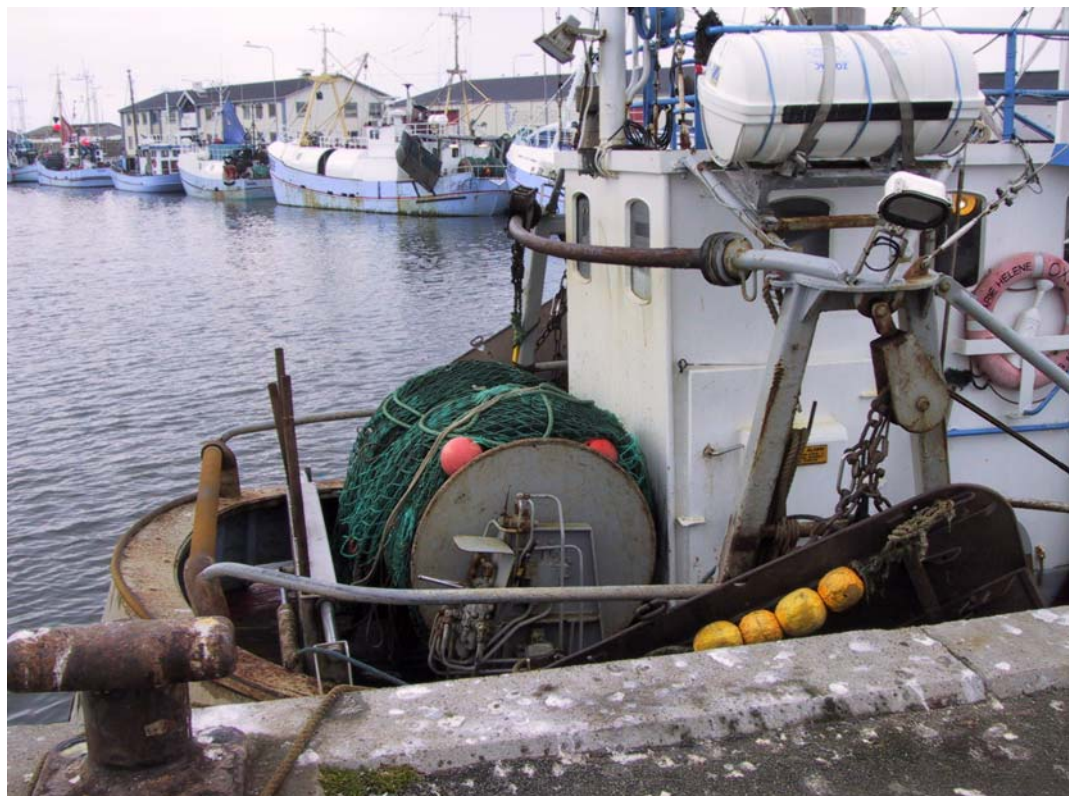
Figur 18 Eksempel type E - Krydserhækket kutter med tromle og fast bøjle, 5 stk
