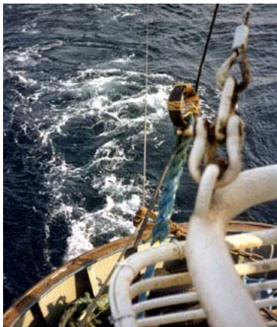
Figur 5 Agtertræk monteret på trawlwire, der på den måde er trukket ind i center.
