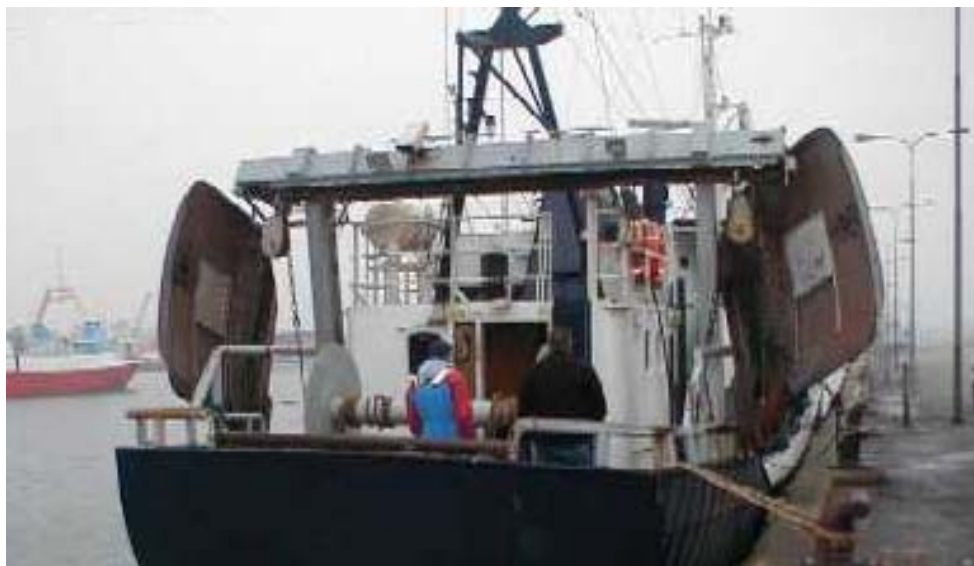
Figur 6 Trawler med køregalge – begge blokke kan køres tværskibs
