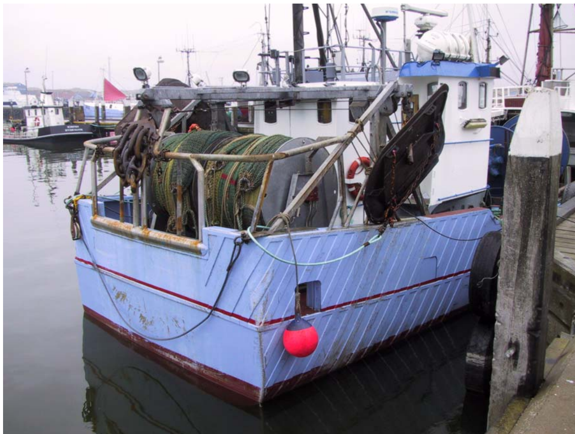
Model 1 Tyskertræk monteret på lønning på spejl
