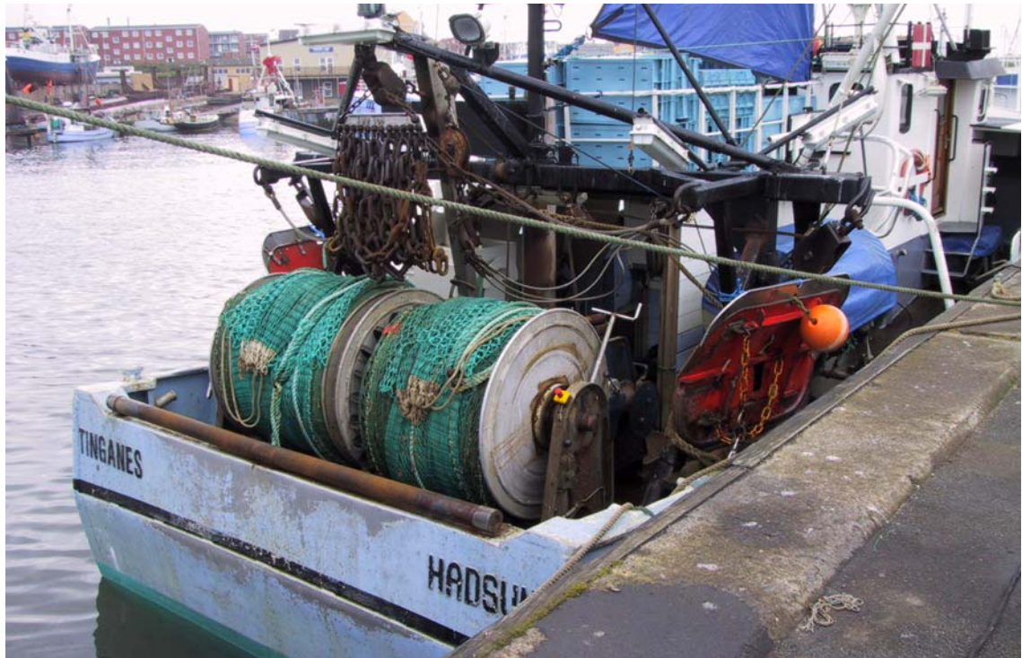
Figur 15 Eksempel type B - spejlgattet med tromler og wire, 22 stk
