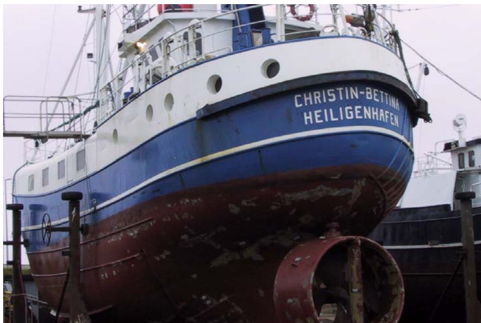
Figur 7 Tysk trawler med køreskinne rundt hæk. Denne trawler har i øvrigt også rordyse, der giver forbedret styreevne under fiskeri i forhold til almindeligt pladeror
