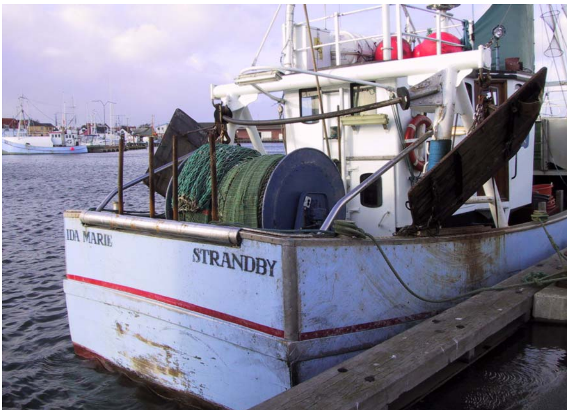
Model 2 Tyskertræk med fast bøjle monteret i galge bag hus
