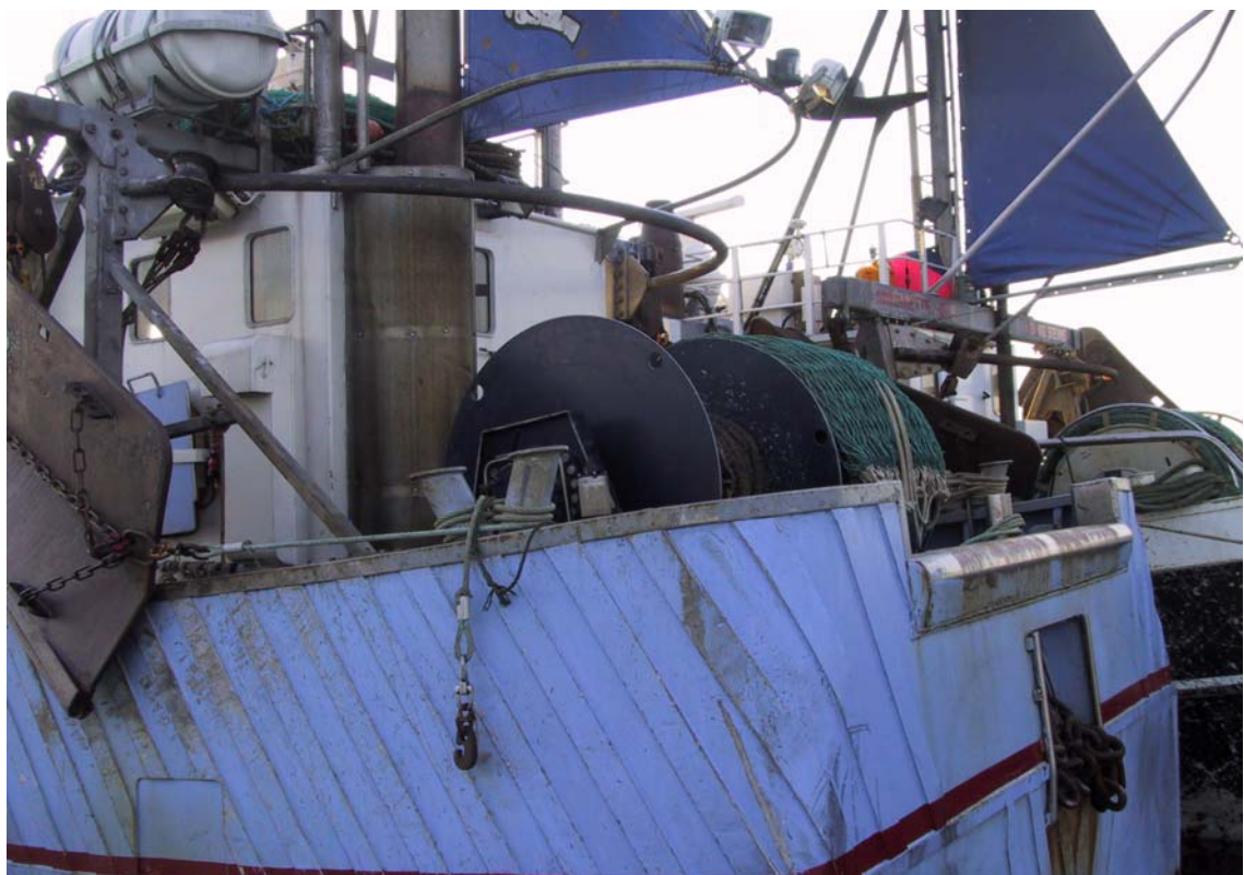
Figur 16 Eksempel type C - Kutter med spejl, tromle og fast bøjle, 20 stk
