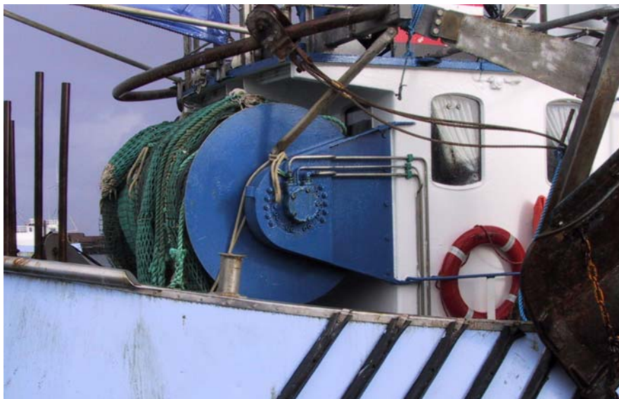
Foto 9 Hvis tromler kan monteres på bagkant styrehus giver det mulighed for at montere en køreskinne på bagkant ruf
