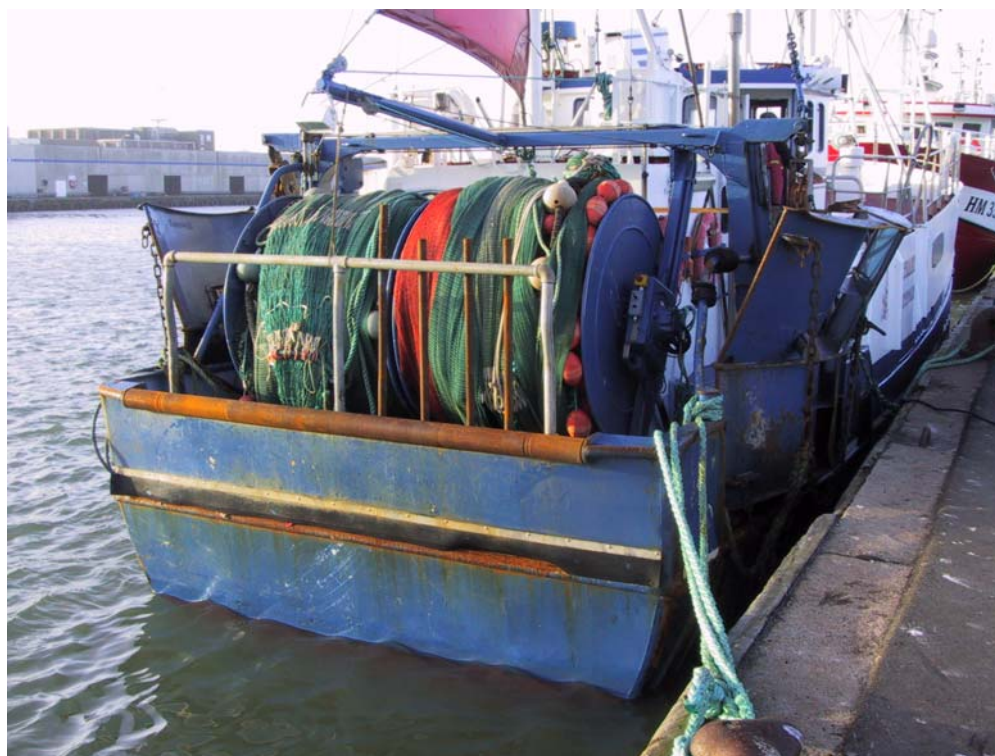
Foto 7 T 424 "Westbank" fisker med køreskinne monteret på bagkant ruf og træk ud gennem slidse i spejl.
