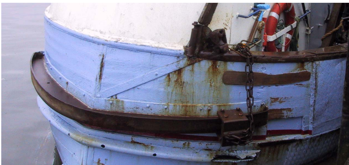
Foto 5 Hvor køreskinnen monteres er det en fordel, at vandlinier ikke er for skarpe. Køreskinnens facon kan også udjævne dette ved at tilvirke kropspladen, så køreskinnen får en en større tilnærmet radius
