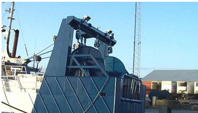
Foto 16 Køregalge med flere vogne, men der kan fremstilles køregalge med blot én vogn beregnet til mindre kuttere.
