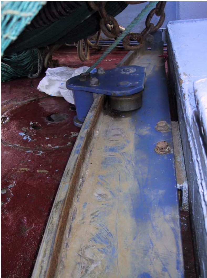
Foto 8 Køreskinne med løbekat påboltet på bagkant ruf T 424 "Westbank".
