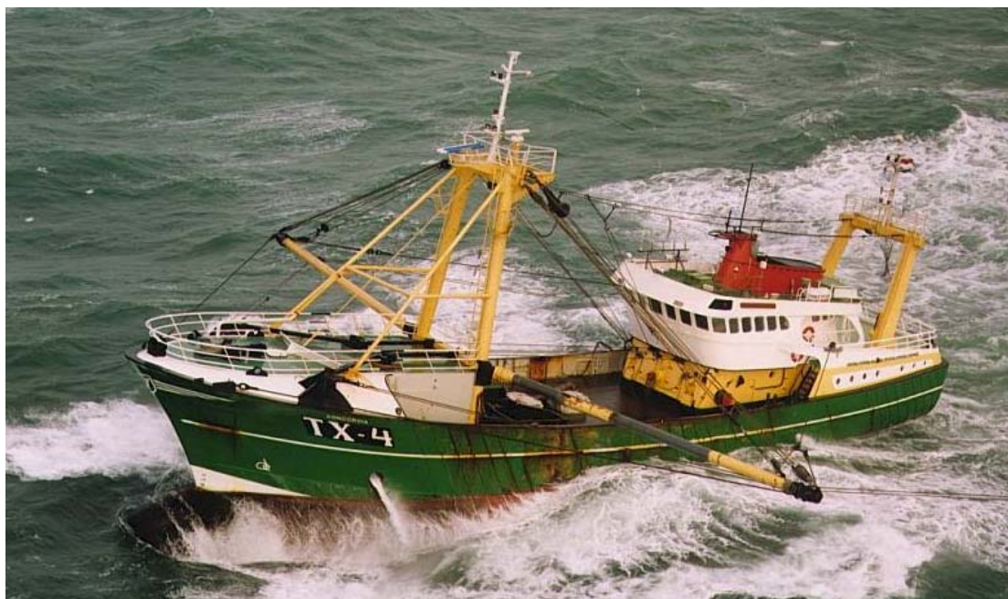
Foto 18 ....også bomtrawlere har også optimeret designet, så slæbebommene er lige foran midtskib nær skibets omdrejningspunkt, så der er maksimal manøvrevevne.
