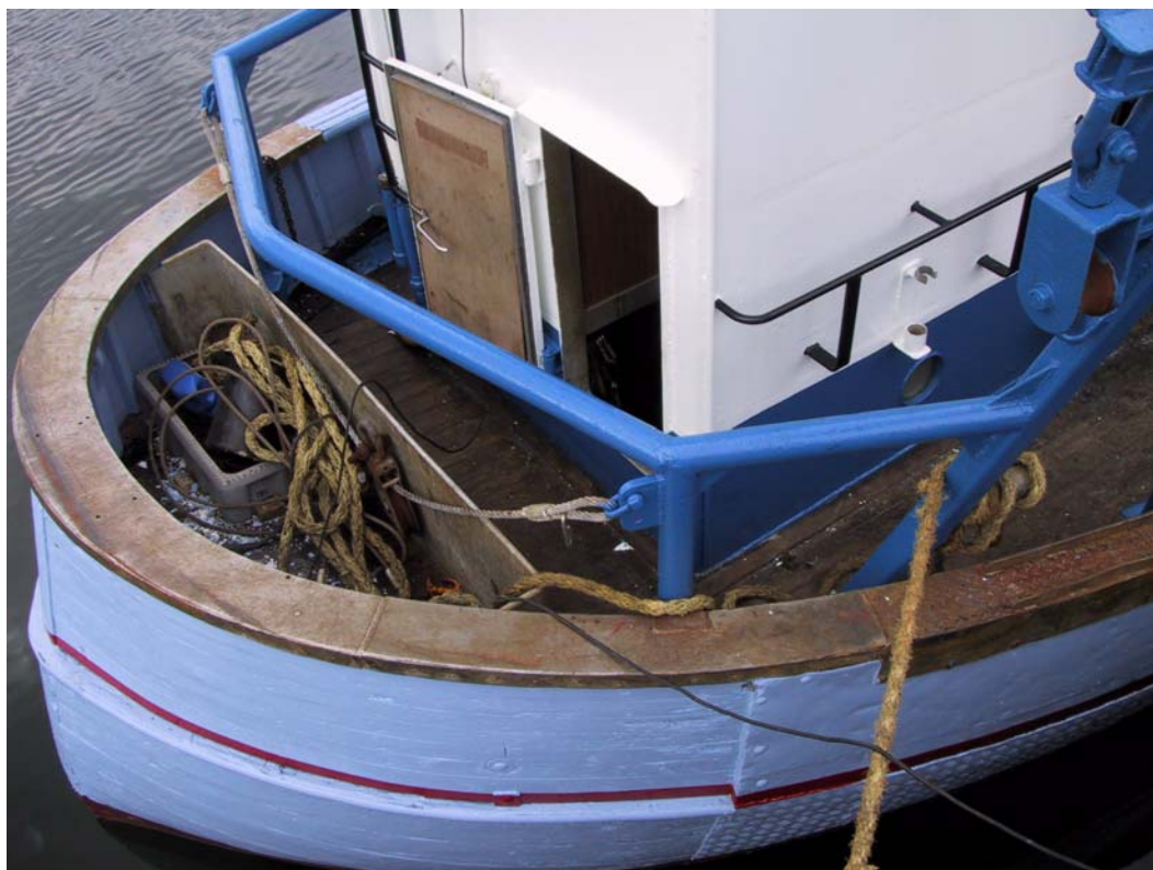
Foto 3 Et arrangement som model nr. 3 ...bemærk wire i tyskertræk er opkørtet, så den under fiskeri kører på overkanten af lønning.
