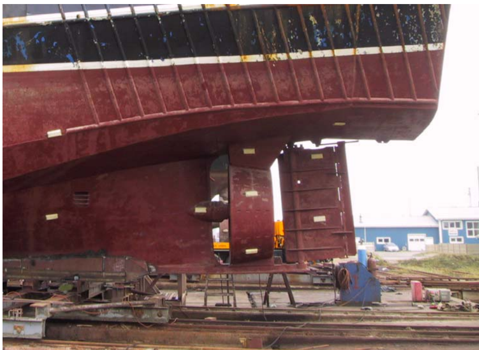
Foto 1 Bevægelig flap på bagkant kan forbedre styreevnen mærkbart og opveje placeringen af tyskertræk agterligt.
