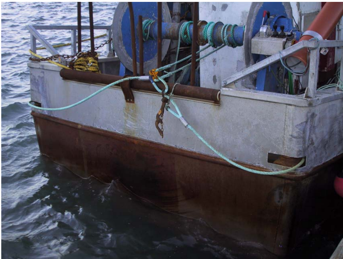
Foto 11 Tyskertræk med anvendelse af rulle i hjørner
