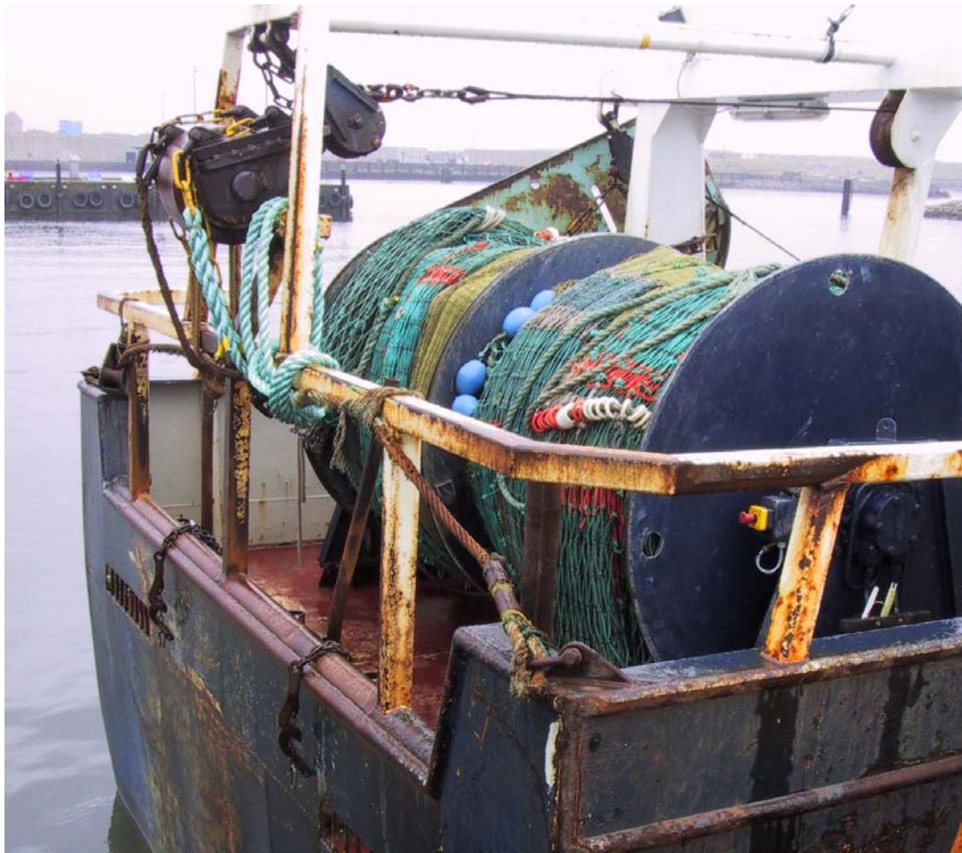
Foto 10 Tyskertræk monteret på overkant lønning
