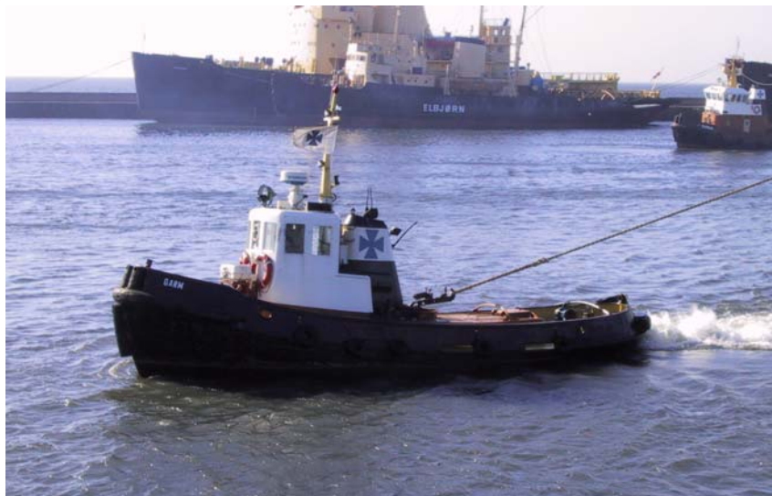
Foto 17 De fleste slæbebåde har deres trækkrog placeret nær midtskib og omdrejningspunktet for at skabe god afstand til rorstamme og opnå maksimal manøvrevevne under arbejdet.
