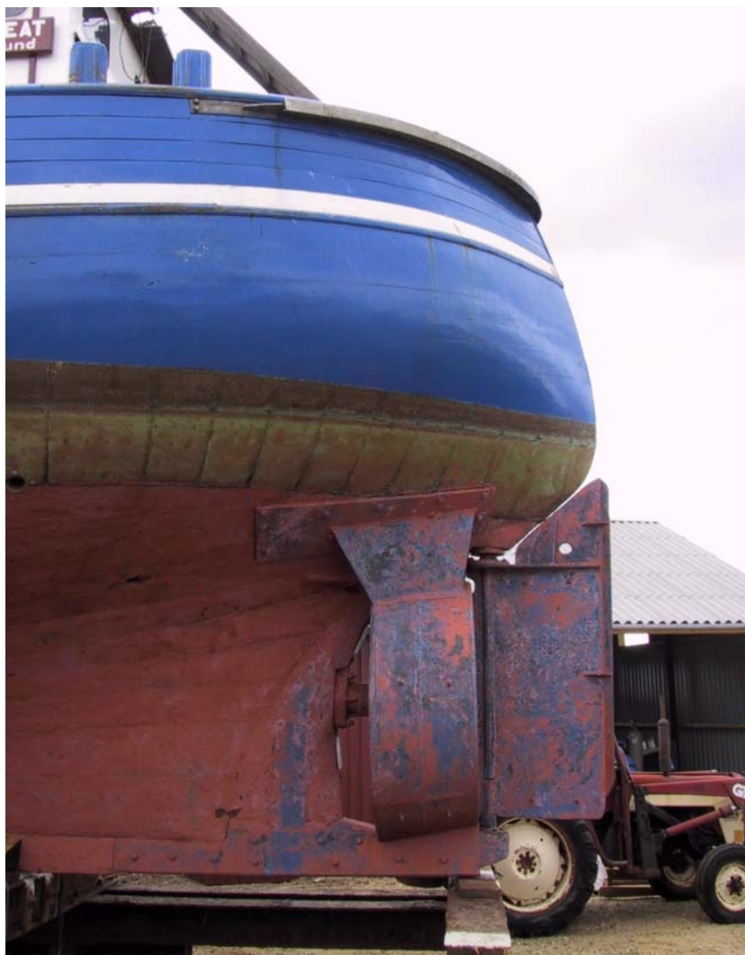
Foto 6 Denne tyske kutter med køreskinne på lønning har optimeret styreegenskaberne ved at trække rorstammen helt ud agter, så armen mellem rorstamme og skibets omdrejningspunkt bliver maksimal.
