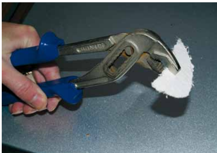
Prøvetagning fra asbestplade til analyse for asbestindhold (registrering). Svar samme dag. Husk forsvarlig indpakning fx i plastpose samt nummer på prøven og beskrivelse af prøvelokalitet.
