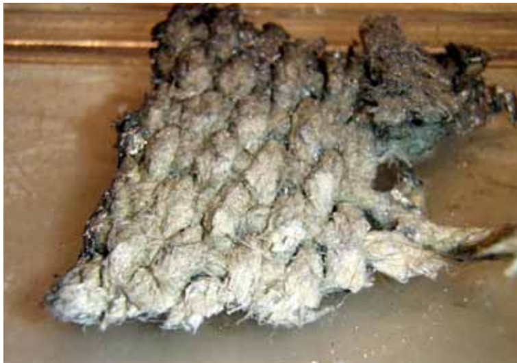
Vævet måtte af hvid asbest. Måtten stammer fra udstødning på RV Ophelia.
